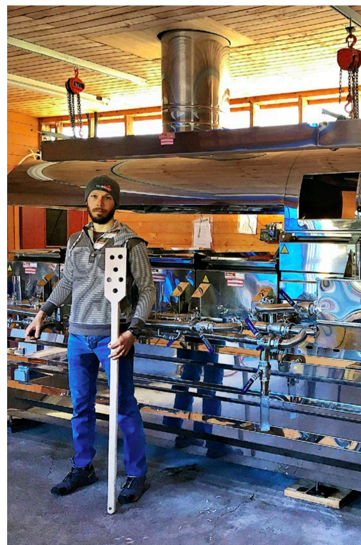
Alexandre Guimond devant son évaporateur de 1,5 par 4,9 mètres, capable de produire jusqu'à 350 litres de sirop d'érable par heure.
